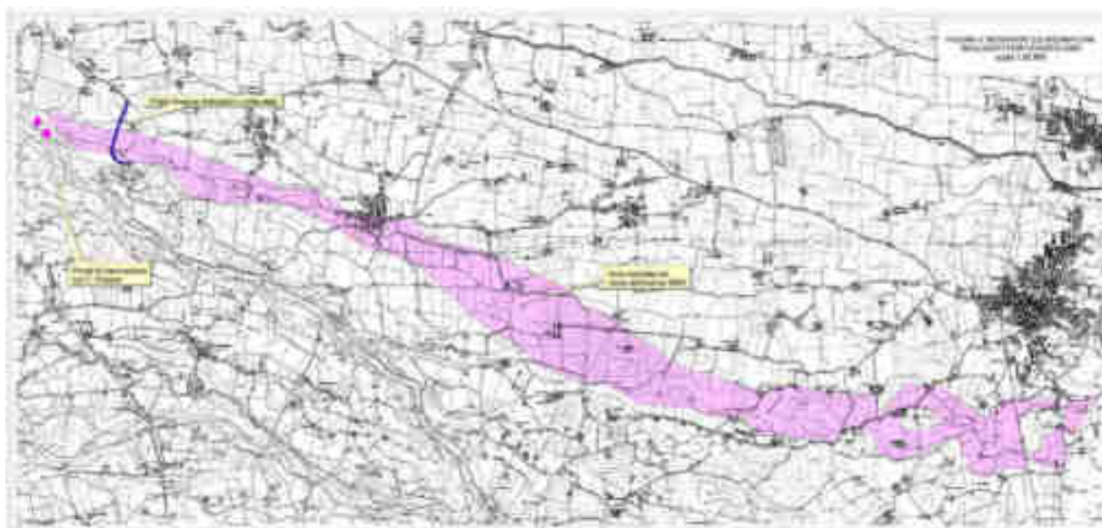
Figura 3 - Mappatura dell'allagamento provocato dall'esonazione del Chisone in loc. Galoppatoio (frecche viola e area rosa) con indicazione della posizione dell'argine (linea blu)(fonte: PRG Vigone Variante Strutturale 2007).
